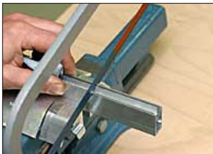
4 Mit einer Metallsäge kürzen
