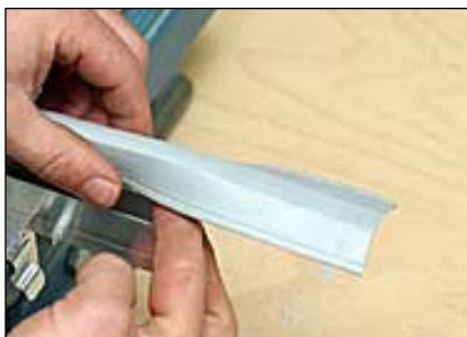
7 Dichtprofil wieder in die Halteschiene drücken
