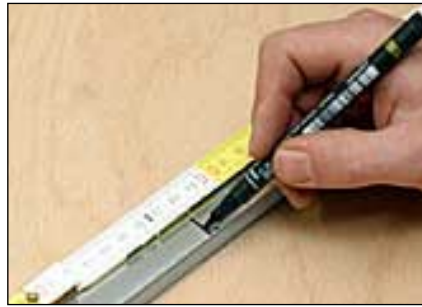
2 Kürzungsseite: Seite ohne Auslöser Schnittstelle anzeichnen
