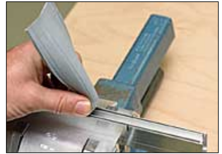
3 Dichtung einspannen und Dichtprofil bis hinter der Schnittstelle aus der Halteschiene ziehen
