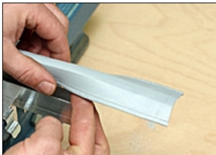
7 Dichtprofil wieder in die Halte- schiene drücken
