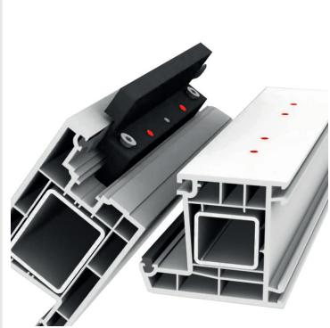
Effectuer les 6 trous de fixation (4 dans le dormant, 2 dans l'ouvrant dans le châssis à l'aide du gabarit TB-Force.
